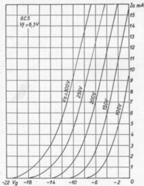
Fig. 139 - Caratteristiche mutue del triodo 6C5.
