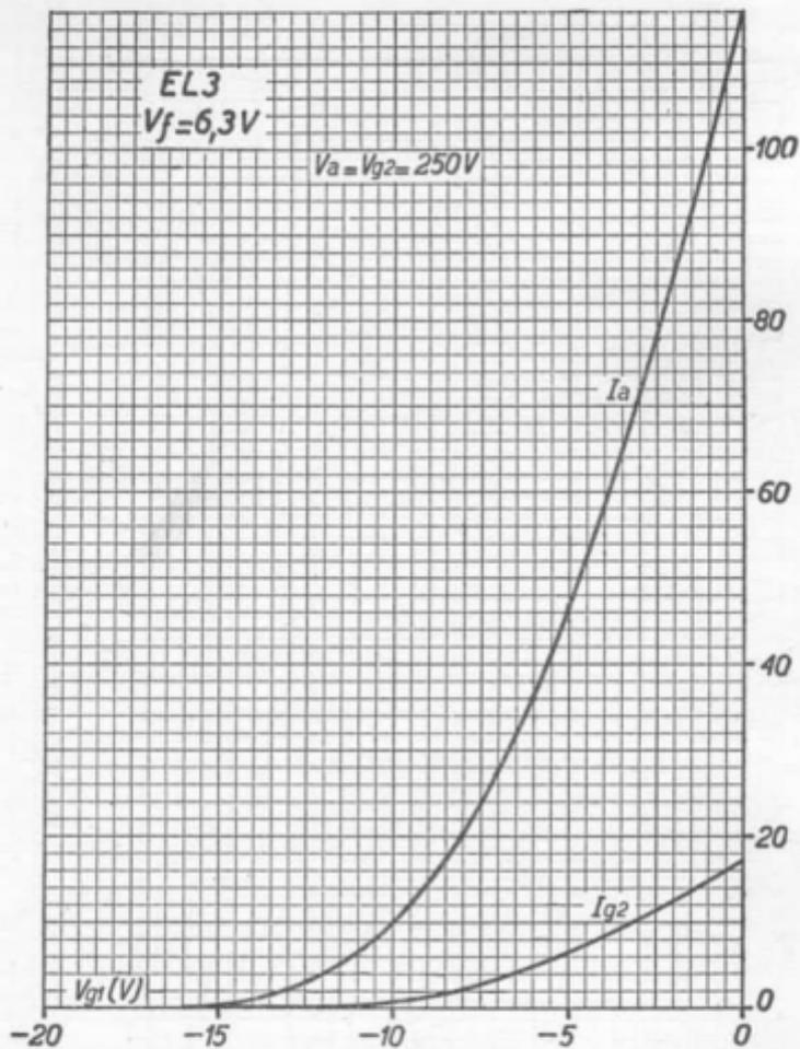
Fig. 145 - Caratteristiche mutue del pentodo EL3.
