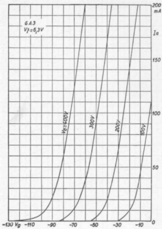
Fig. 143 - Caratteristiche mutue del triodo 6A3.
