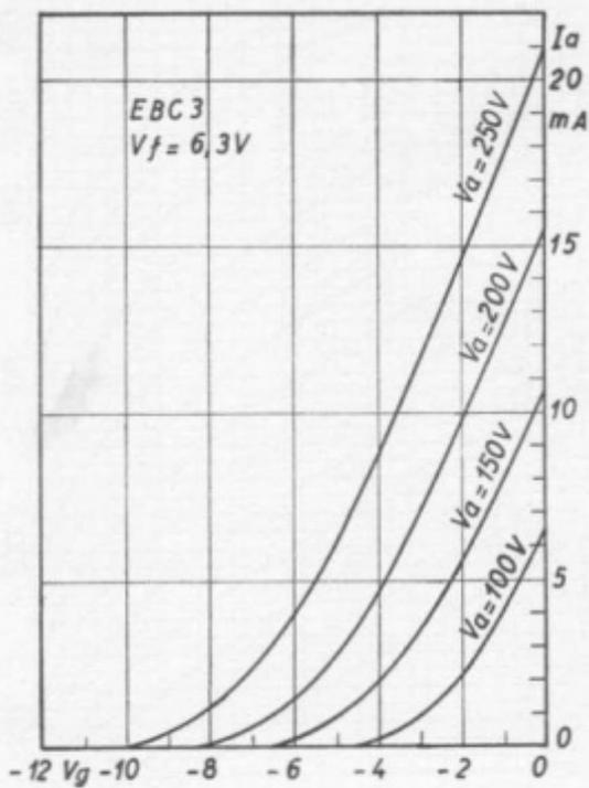
Fig. 141 - Caratteristiche mutue del triodo EBC3.
